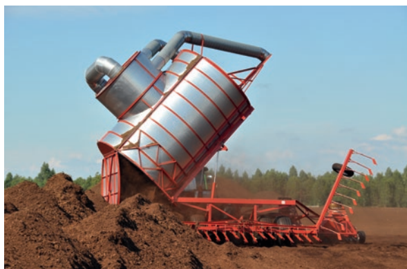
Zbieranie jasnego torfu metodą fрезования
